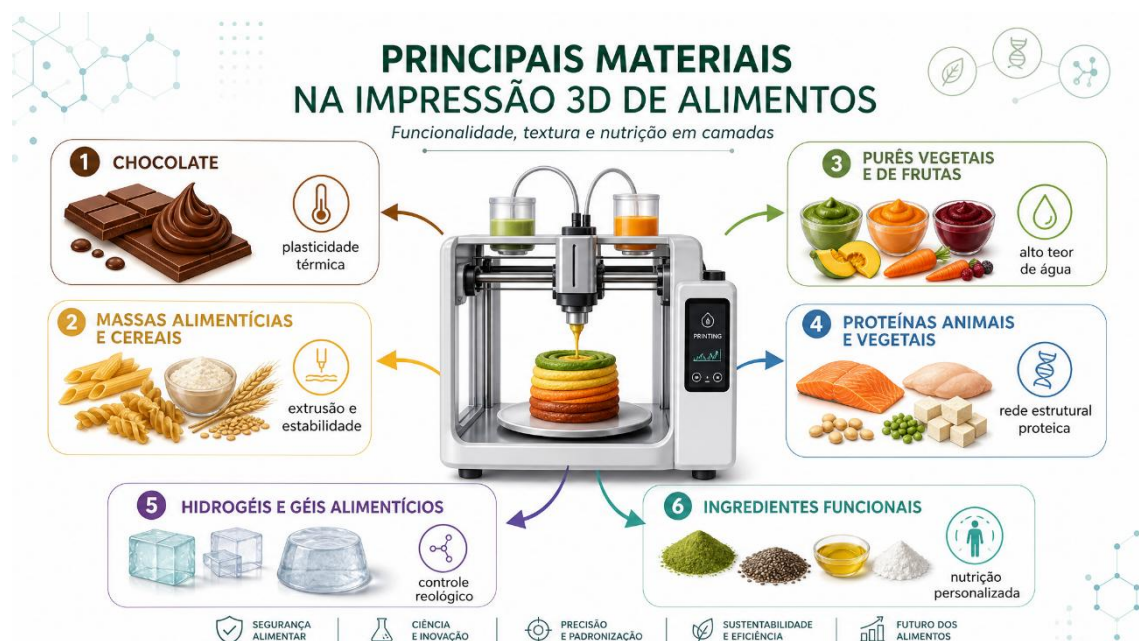
Figura 2: Principais materiais utilizados na impressão 3D de alimentos e propriedades reológicas essenciais para impressão.
