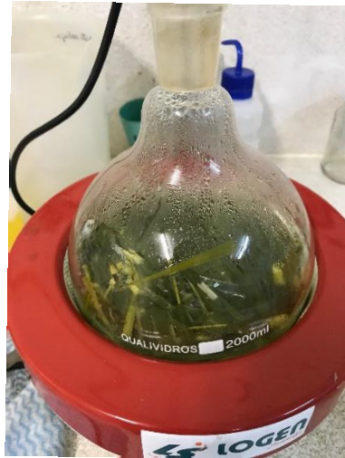
Figura 1 Balão para extração
