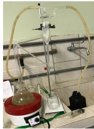
Figura 2 Vidrarias acopladas para extração
