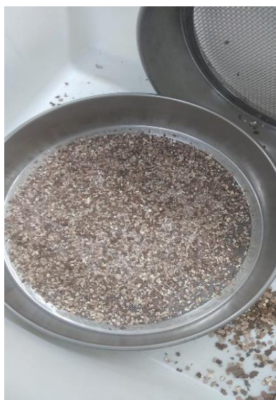
Figura 03: Exemplo de padronização e separação de casca e entrecasca de resíduo agroindustrial, passada o mesmo por tamizes com granulometria determinada, com o objetivo de serem utilizadas como substratos em fermentações em estado sólido.
