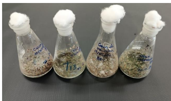
Figura 04: Fermentação em estado sólido realizada em erlenmerys utilizando resíduos agroindustriais como substratos para o crescimento fúngico.
