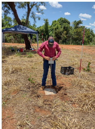
Figura 3: Levantamento da resistência do solo à penetração no campus do IFMS - Campus de Nova Andradina/MS - Brasil.
